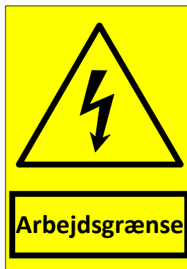
Figur 11.1.8.1-1 Advarselstavle til opsætning i mast.
