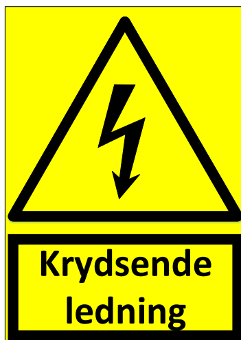
Figur 11.1.8.2-5. Advarselstavle for krydsende ledning.
