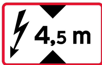
Figur 10.13.3 -1 Skilt for niveauoverskæring, der skal anvendes, når der skiltes mod offentlig vej (skiltet er påkrævet i færdselsloven som UA73)
