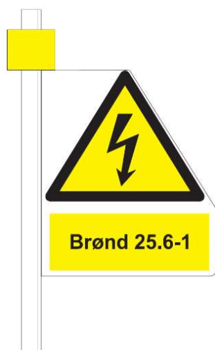
Figur 10.12.11-1 Skilt ved kabelbrønd på stolpe.
