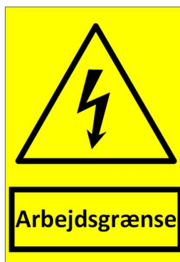
Figur 11.1.4.1-1 Advarselstavle til opsætning i mast.
