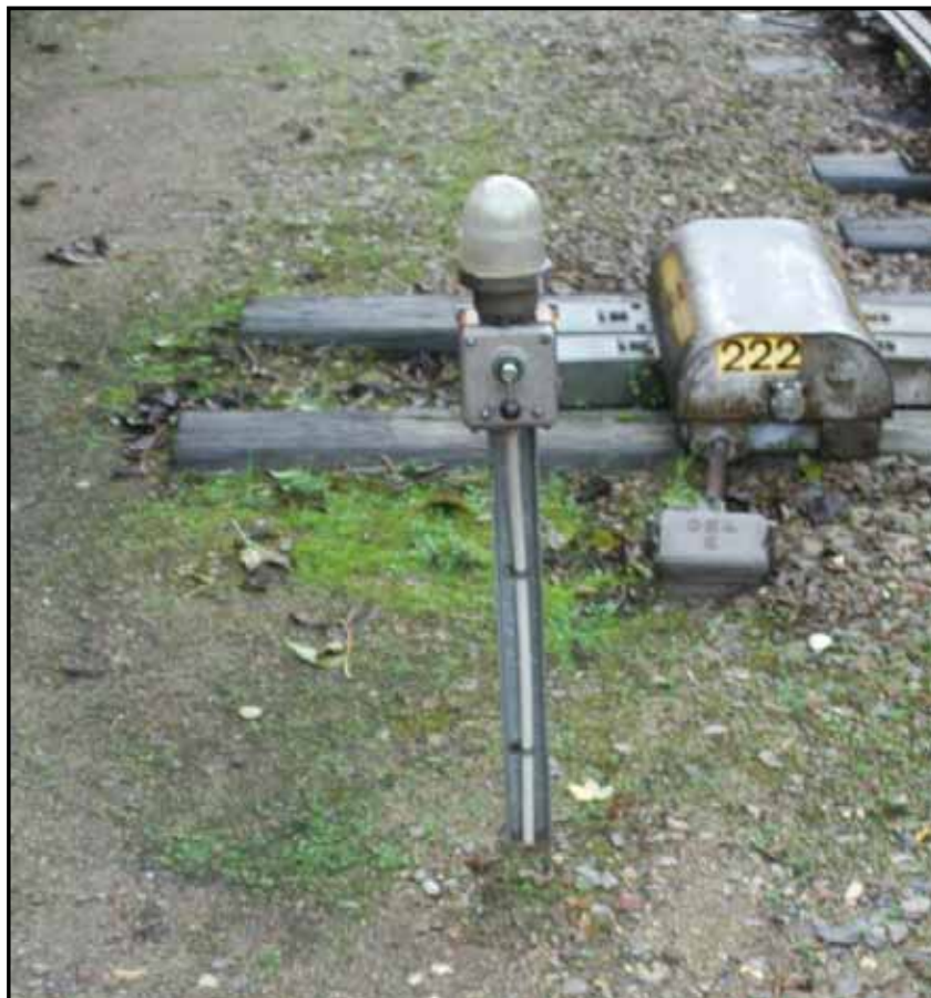
Centralaflåst sporskifte med el-stedbetjening
