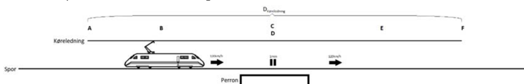
Figur 9 – Køreledningslængde ved trinbræt
