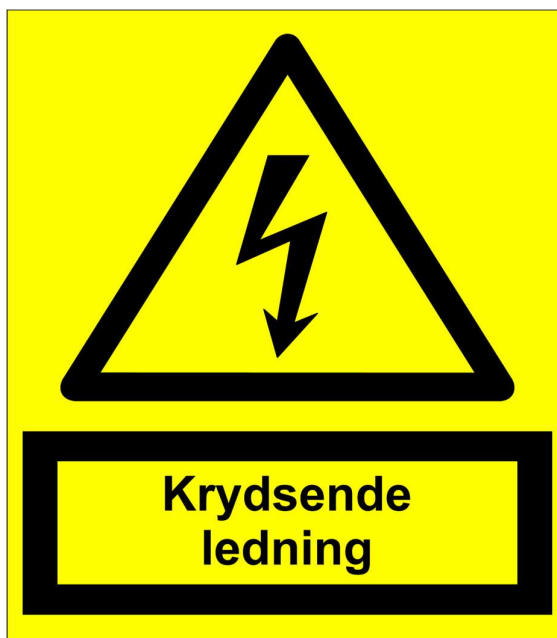
Figur 11.1.8.2-5 Advarselstavle for krydsende ledning.
