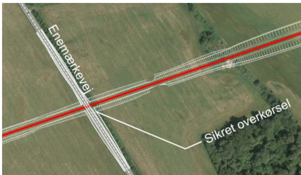
Figur 37. Ved Enemærkevej (st. 5+170) etableres en sikret overkørsel.
