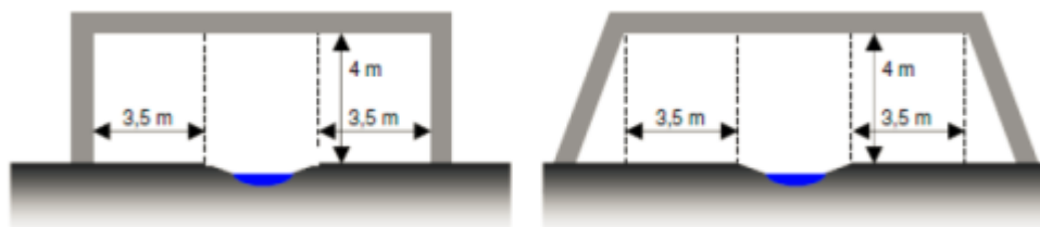
Figur 73. Tværsnit af våde underføringer, /12/.
