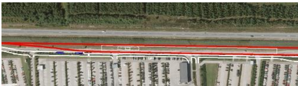
Figur 59. Alternativ for Billund Lufthavn station langs Lufthavnsvej med perron til 300 m tog.
