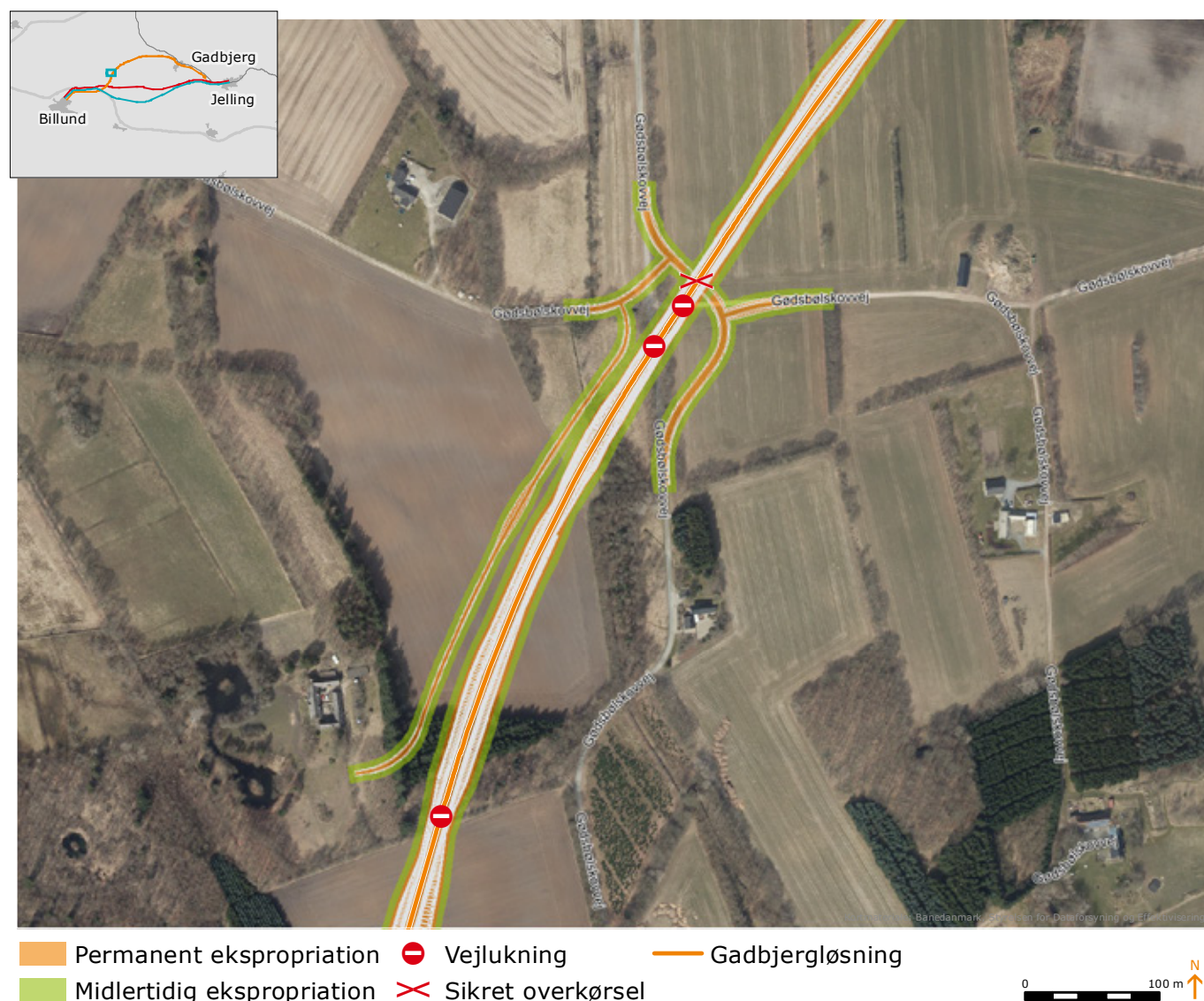
Figur 34. Ændring i lokalområdet ved anlæg af en sikret overkørsel på Gødsbølskovvej.
