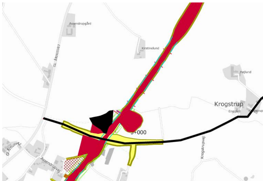
Figur 29. Cykelrute (sort linje) ad Krogstrupvej ved st. 8+820 (rød = baneanlæg, gul = vejanlæg, olivengrøn = arbejdsvej og -areal, rød skravering = udsætning af overskudsjord, sort flade = ekstra eksproprieret areal).
