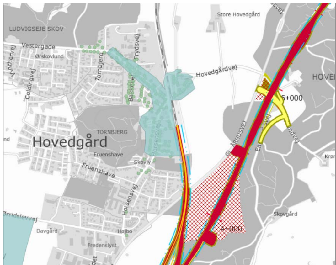
Figur 48. Anlægsprojekt for Vestlig linjeføring i værdifuldt kulturmiljø (blågrøn flade) Hovedgård Stationsby, (rød = baneanlæg, gul = vejanlæg, olivengrøn = arbejdsvej og -areal, rød skravering = udsætning af overskudsjord).
