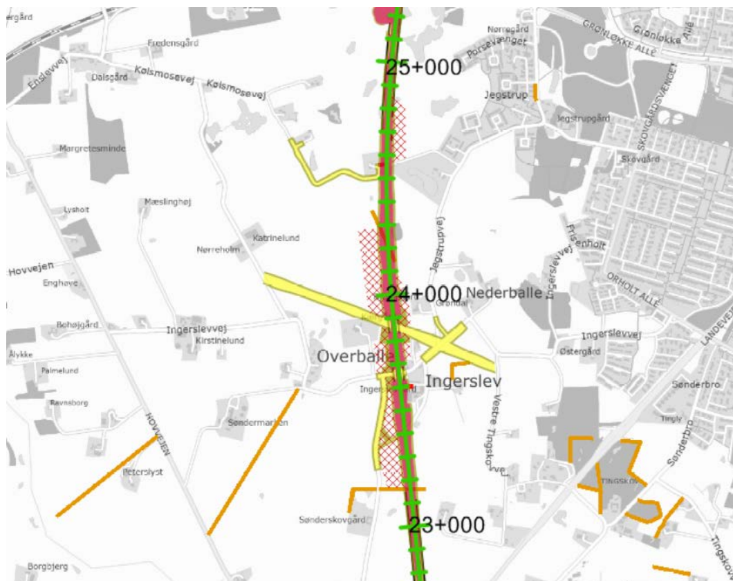
Figur 27. Beskyttede sten- og jorddiger (orange) på Østlig linjeføring for st. 23+000-25+000 (rød = baneanlæg, gul =vejanlæg, olivengrøn = arbejdsvej og -areal, rød skravering = udsætning af overskudsjord).
