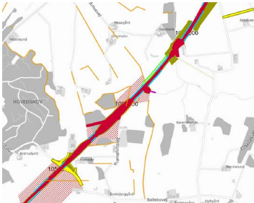
Figur 28. Beskyttede sten- og jorddiger (orange) på Sydøstligt alternativ for st. 104+000-107+000 (rød = baneanlæg, gul = vej anlæg, olivengrøn = arbejdsvej og -areal, rød skravering = udsætning af overskudsjord).
