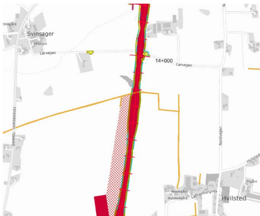
Figur 19. Beskyttede sten- og jorddiger (orange) på Vestlig linjeføring for st. 13+000-14+000 (rød = baneanlæg, gul = vejanlæg, olivengrøn = arbejdsvej og -areal, rød skravering = udsætning af overskudsjord).
