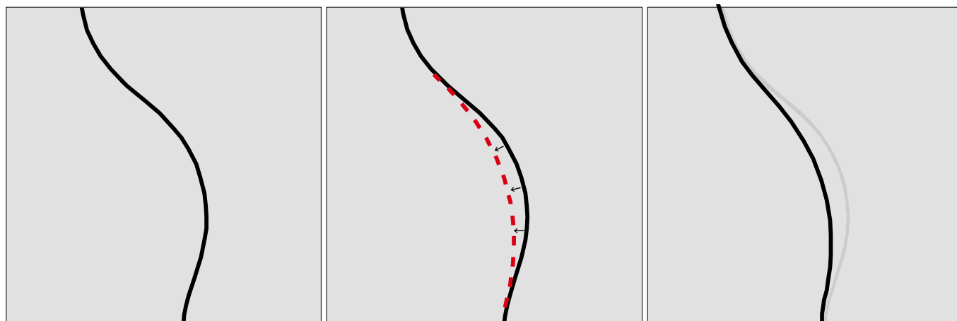
Principskitse af hvordan banen forløb gøres mere lige og dermed bliver klar til højere hastighed. Ved mindre udretninger trækkes sporet på plads til et mere lige forløb.
